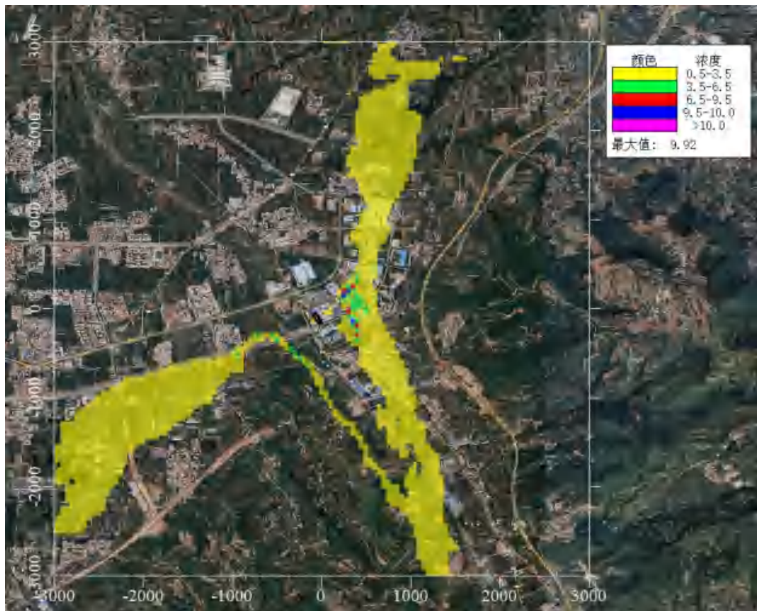
图 5.2-22 区域网格点非甲烷总烃 1 小时地面浓度贡献值等值线图 单位： \mu\text{g}/\text{m}^3
