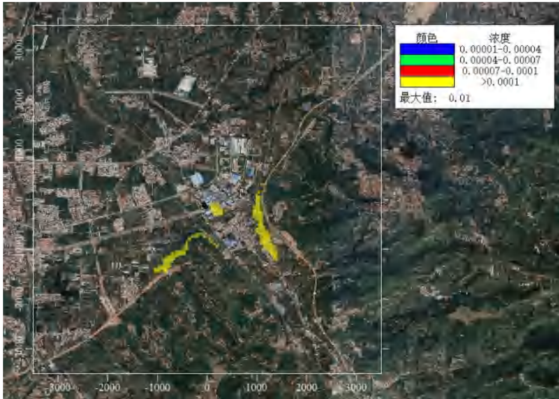
图 5.2-17 区域网格点 SO 2 年均地面浓度贡献值等值线图 单位: \mu\text{g}/\text{m}^3
