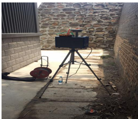
厂区厂界南侧区处颗粒物无组织排放
