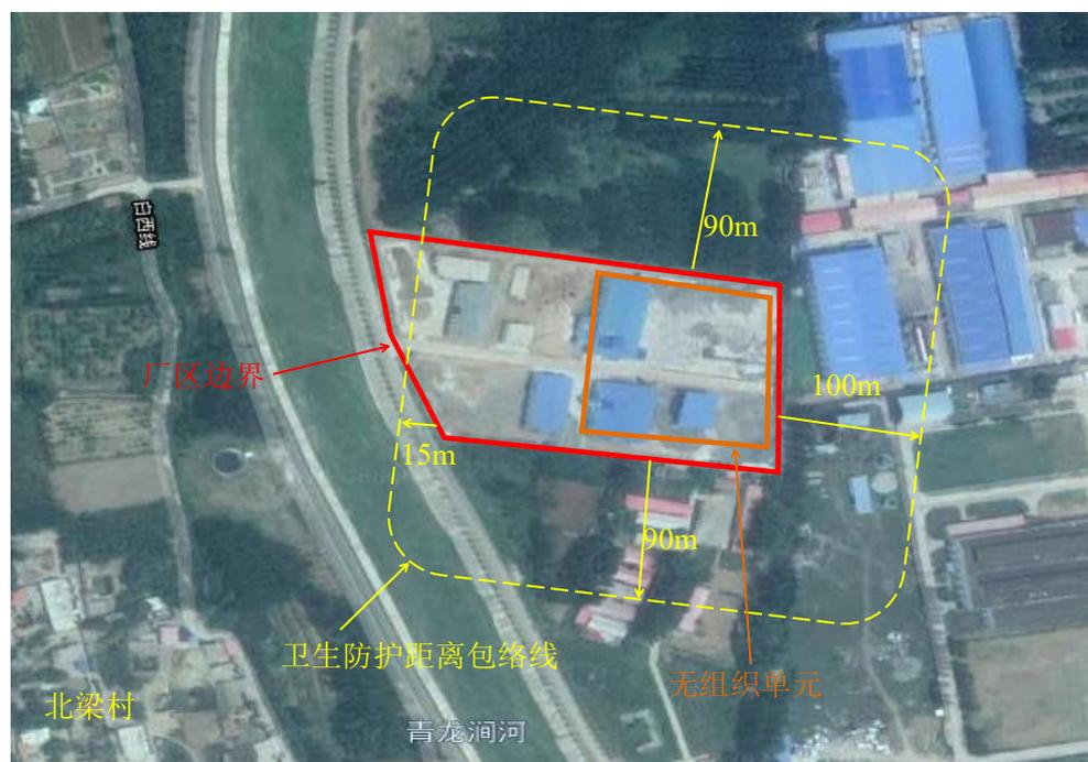
图 4 卫生防护距离包络线图
