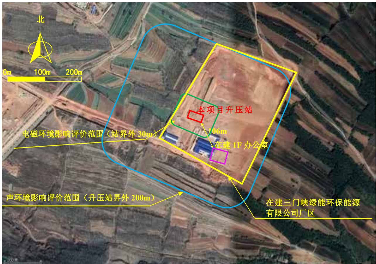
图 1-2 三门峡绿能环保能源有限公司三门峡生活垃圾焚烧发电项目配套 110kV 升压站周边环境示意图
