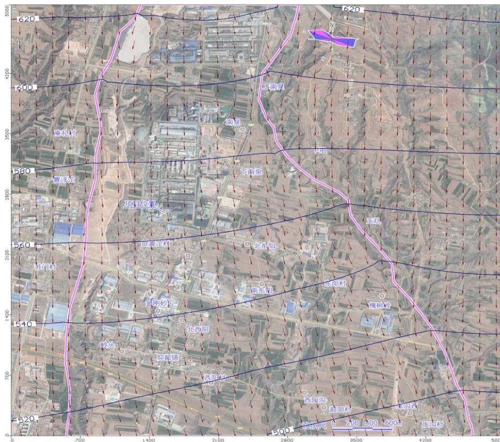
图 5.3-10 模拟区地下水等水位线和流场示意图 单位：m
