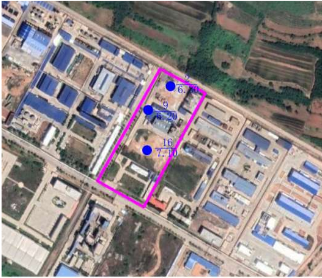
图例 厂址区 2 地质勘探孔 6.30 孔深
