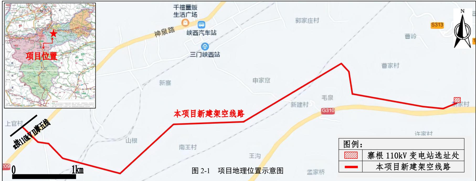
本项目新建寨根 110kV 变电站，户外布置，主变终期规模  $2\times 90\text{MVA}$ ，本期全部建设完成；新建 110kV 输电线路路径长度 7.5km，同塔双回架空架设。
