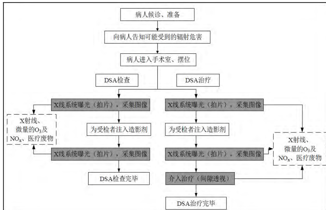
图 9-4 DSA 操作流程及产污环节示意图
