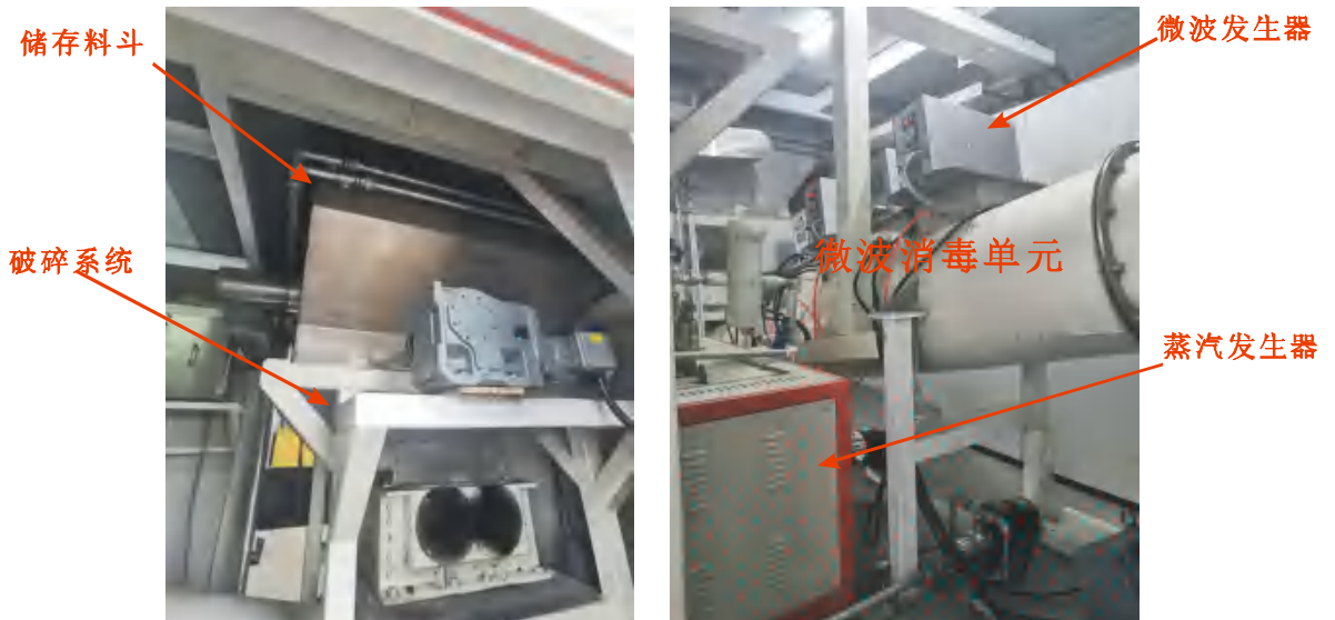
图 3.2-3 项目拟采用的微波消毒处理系统内部结构样图
