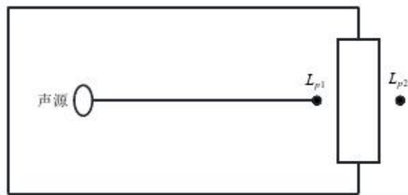
图 7 室内声源等效为室外声源图例
