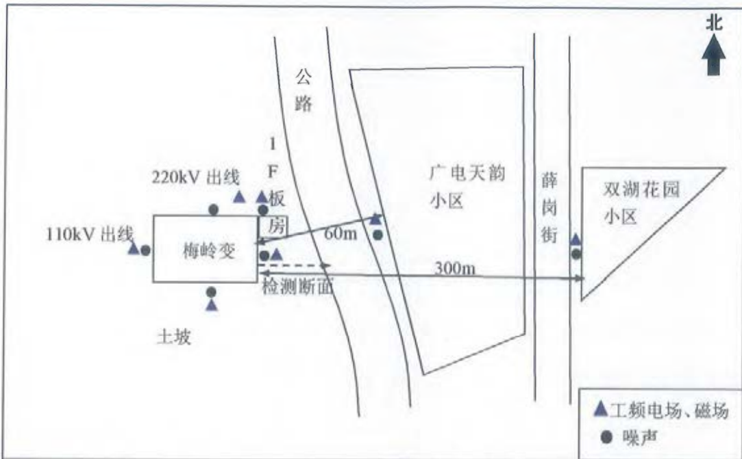
检测示意图 4 220kV 梅岭变电站四周厂界及保护目标检测示意图
