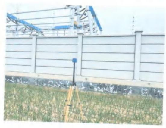
满仓220kV变电站西侧围墙外电磁检测照片
