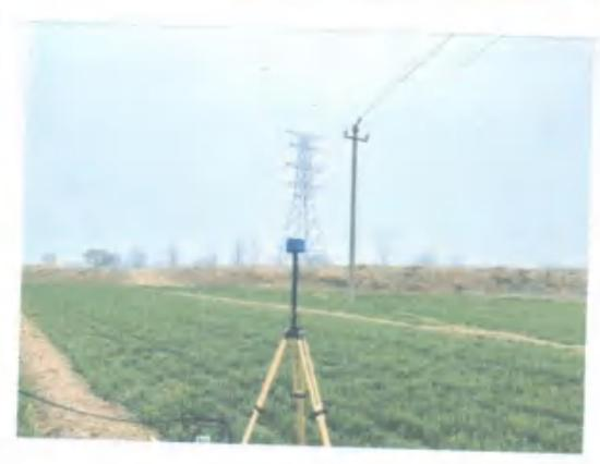
220kV单回架空线路衰减断面电磁检测照片
