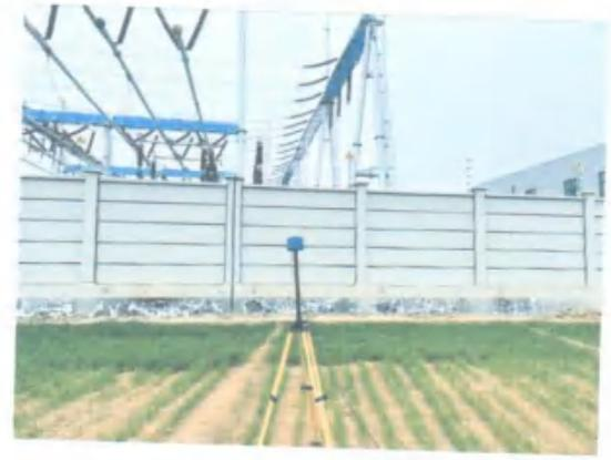
满仓220kV变电站南侧围墙外电磁检测照片
