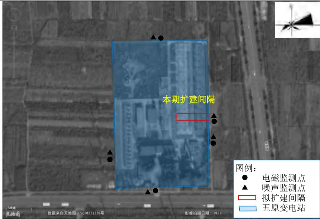
图 3-2 监测点位布置图（五原变电站间隔扩建工程）
