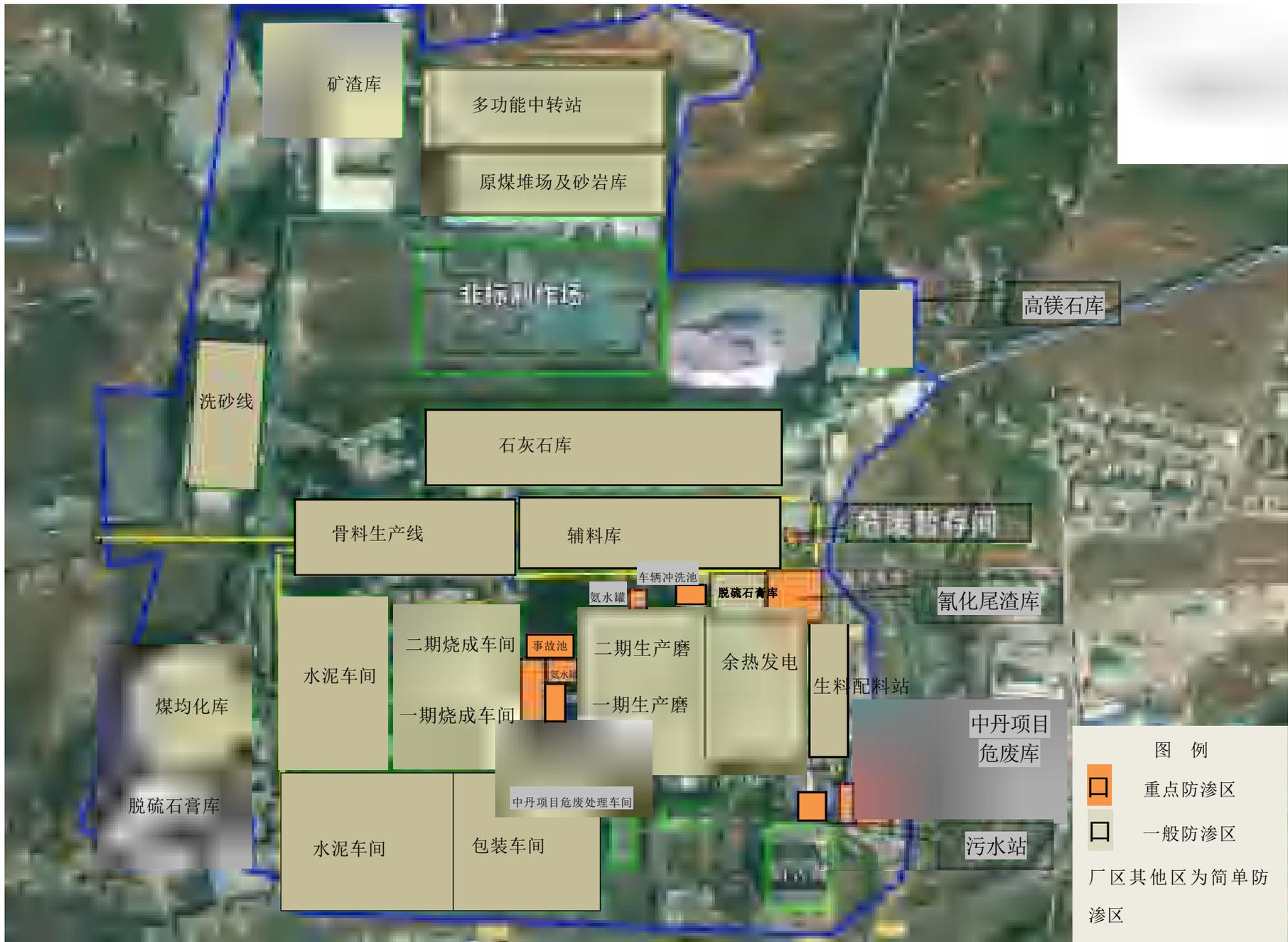
附图 13 技改工程所在厂区地下水分区防渗图
