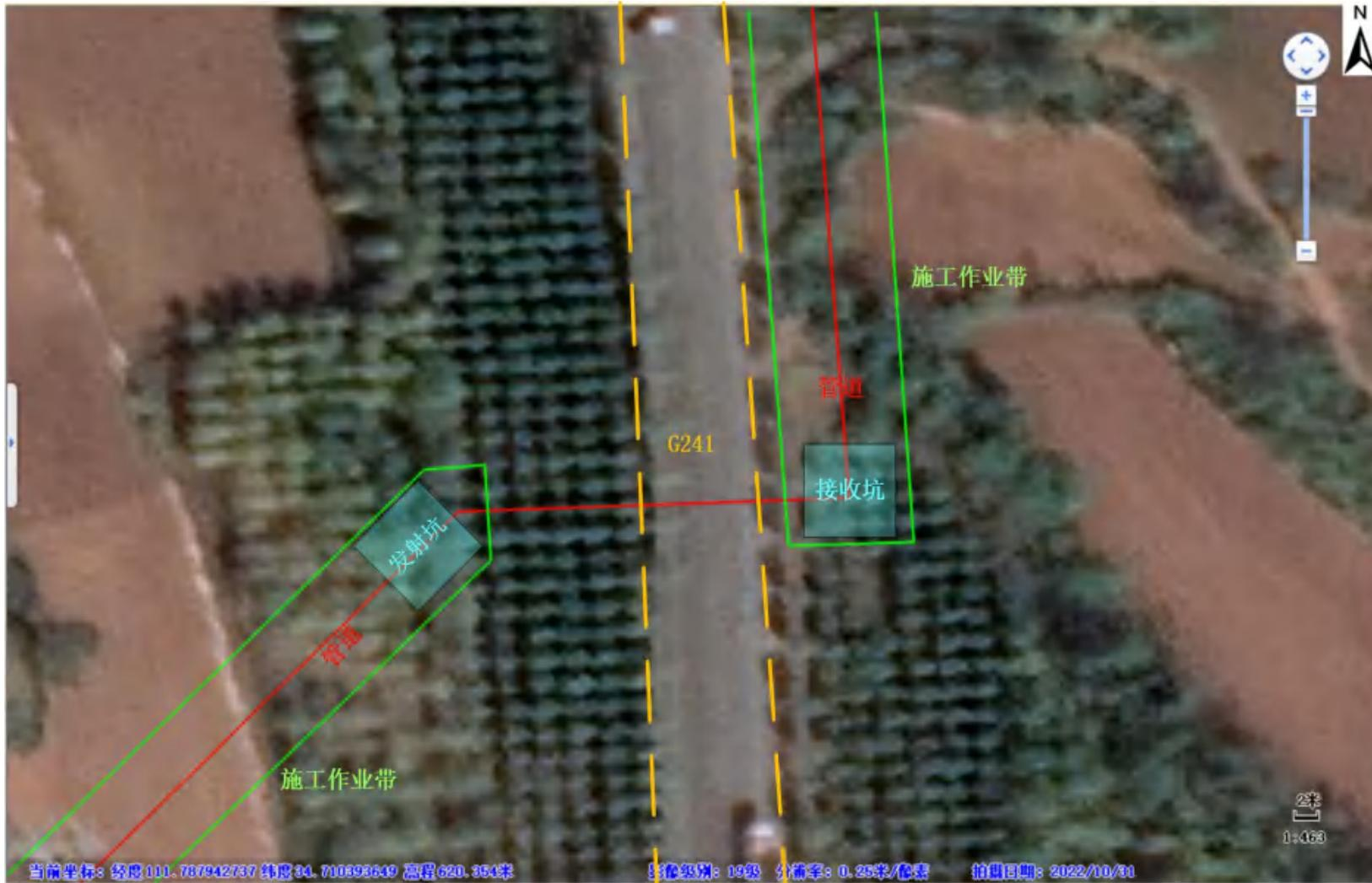
图 3.6-3 顶管作业施工布置图（跨越 G241）
