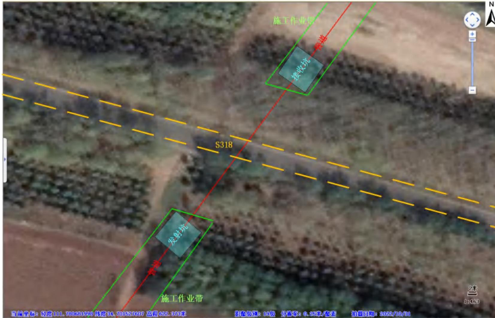
图 3.6-2 顶管作业施工布置图（跨越 S318）
