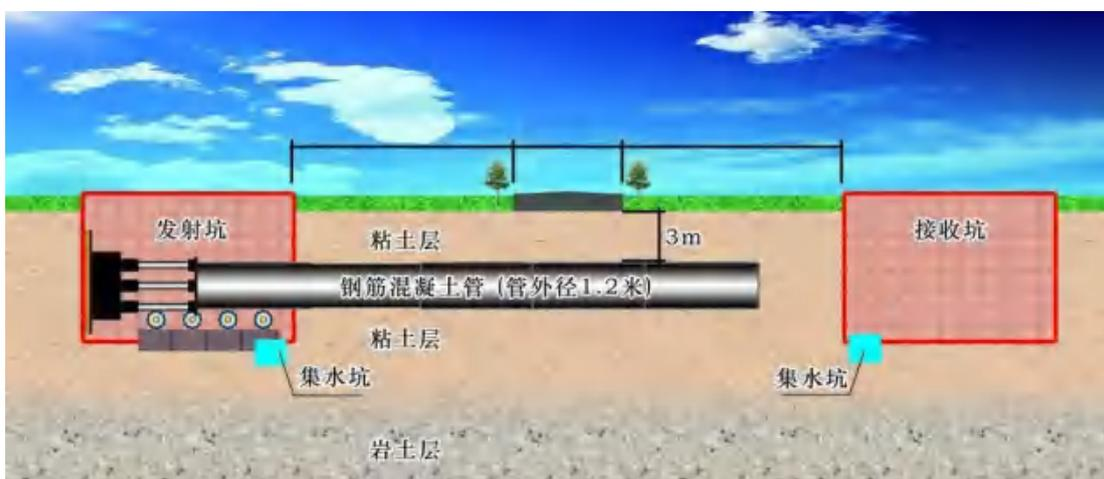
图 3.7-9 顶管施工工艺示意图
