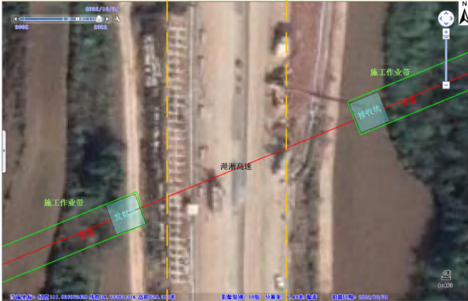
图 3.6-4 顶管作业施工布置图（跨越滉浙高速）
