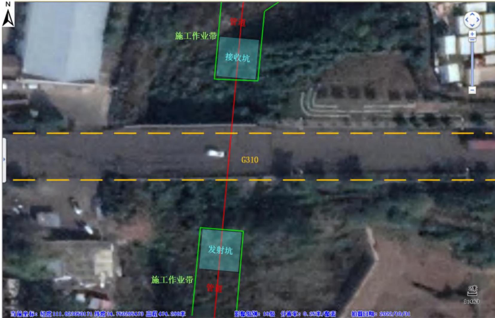
图 3.6-5 顶管作业施工布置图（跨越 G310）
