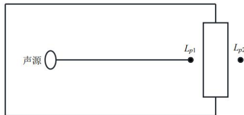
图 4 室内声源等效为室外声源图例
