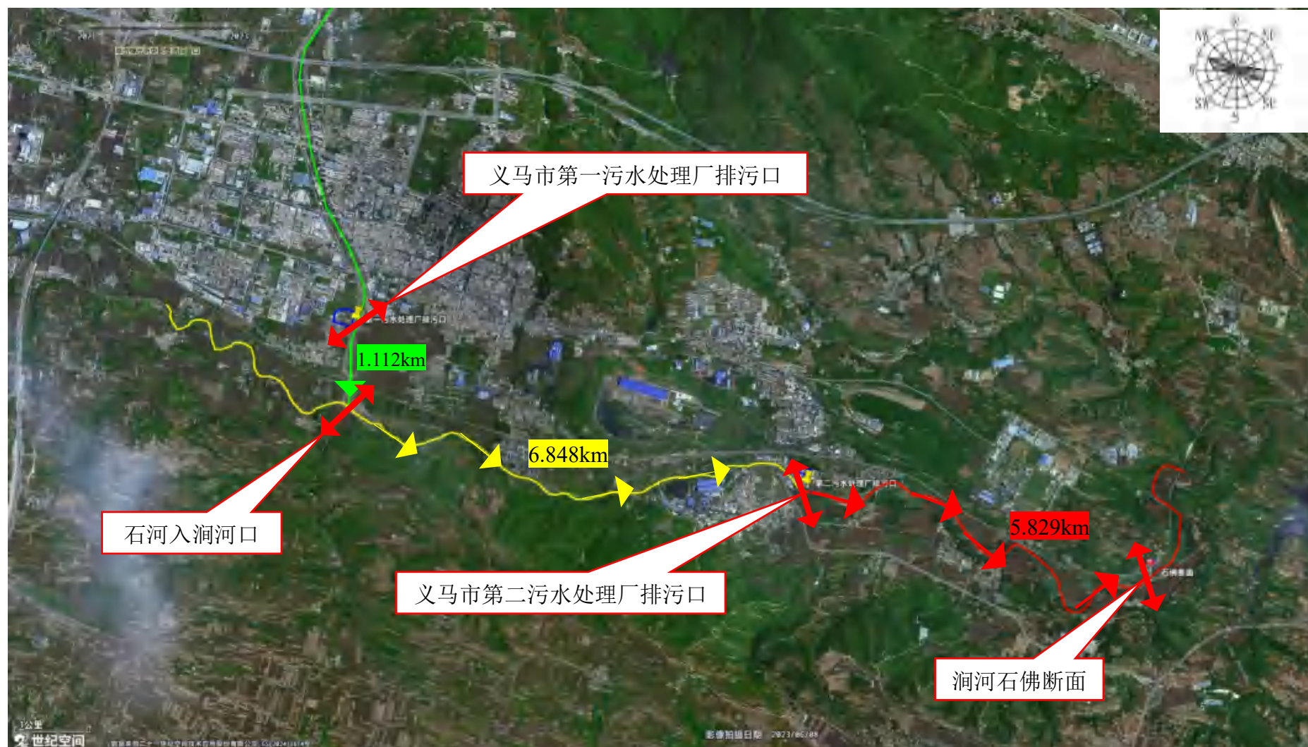
图 5.3-1 污水处理厂排水路线图
