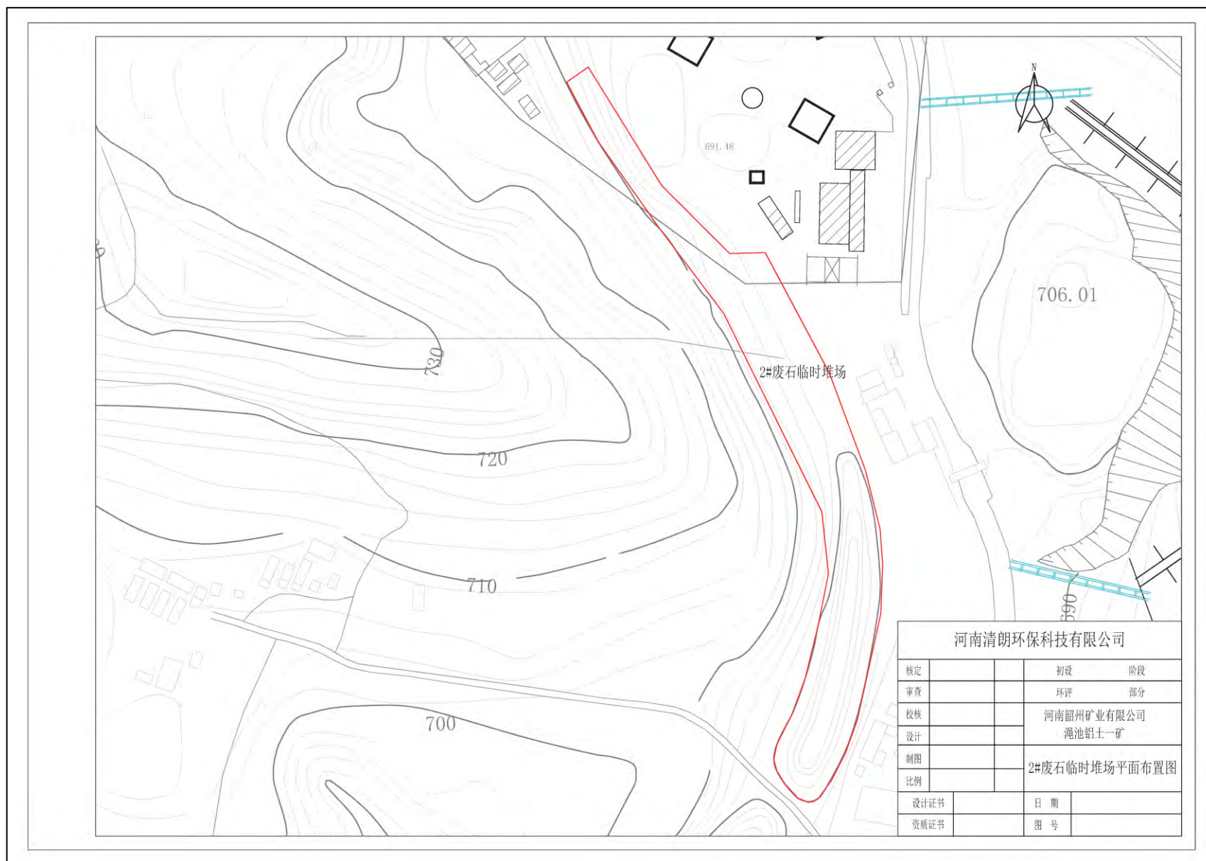
附图4-8 2#废石临时堆场平面布置图
