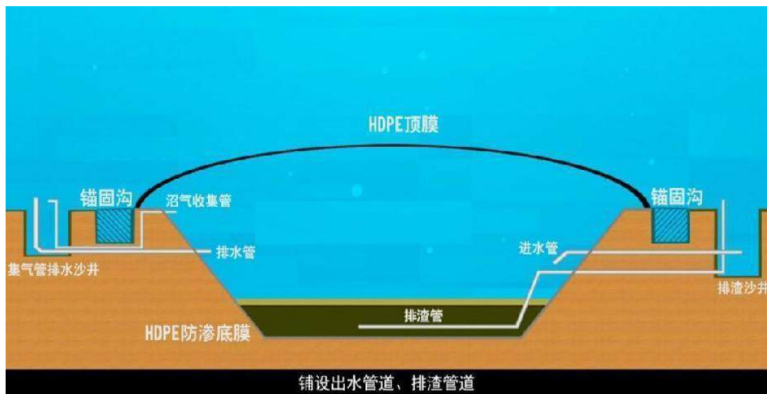
图 6-2 黑膜沼气池结构示意图
