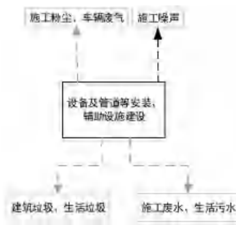
图 2.4-1 施工期流程及主要产污环节图
