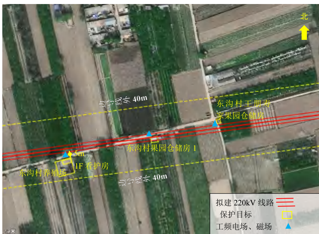
图 2-3 本工程沿线监测布点示意图
