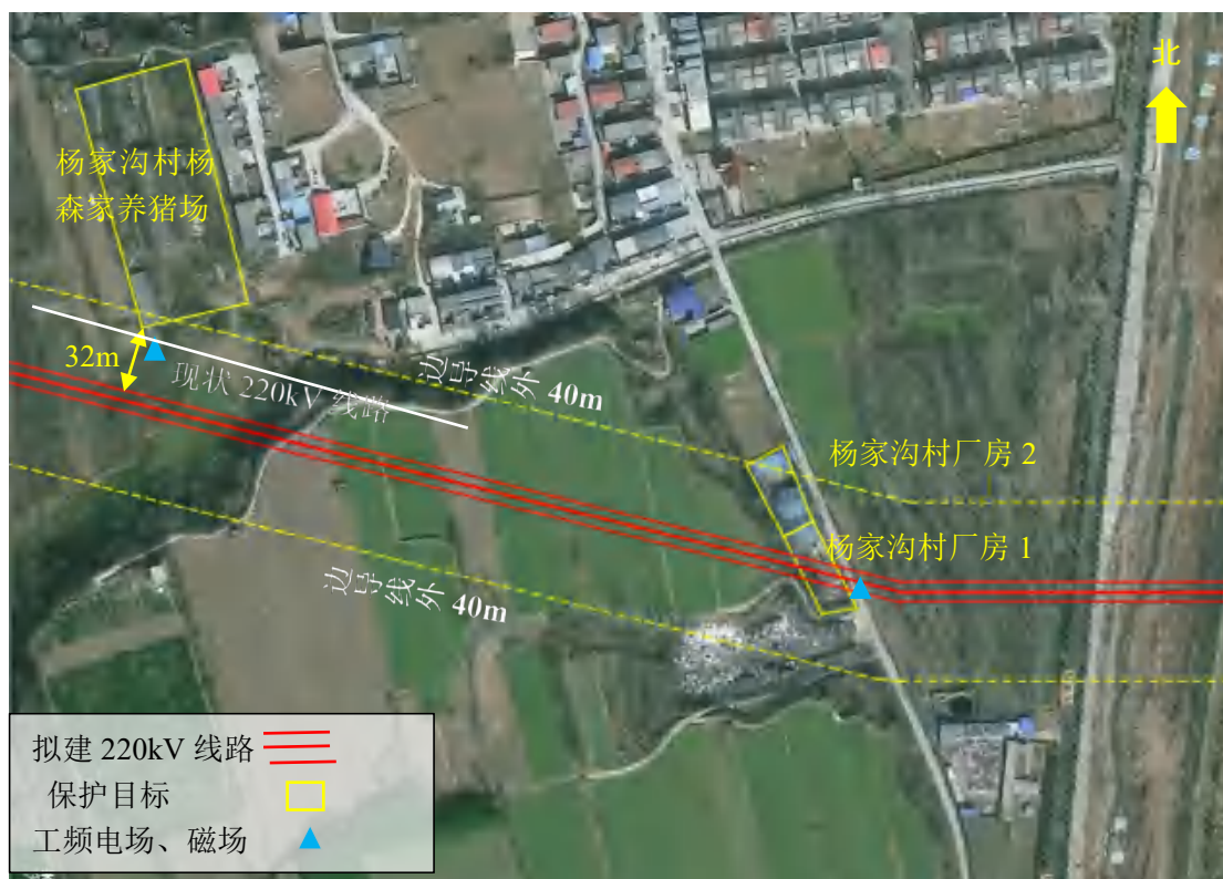
图 2-2 本工程沿线监测布点示意图
