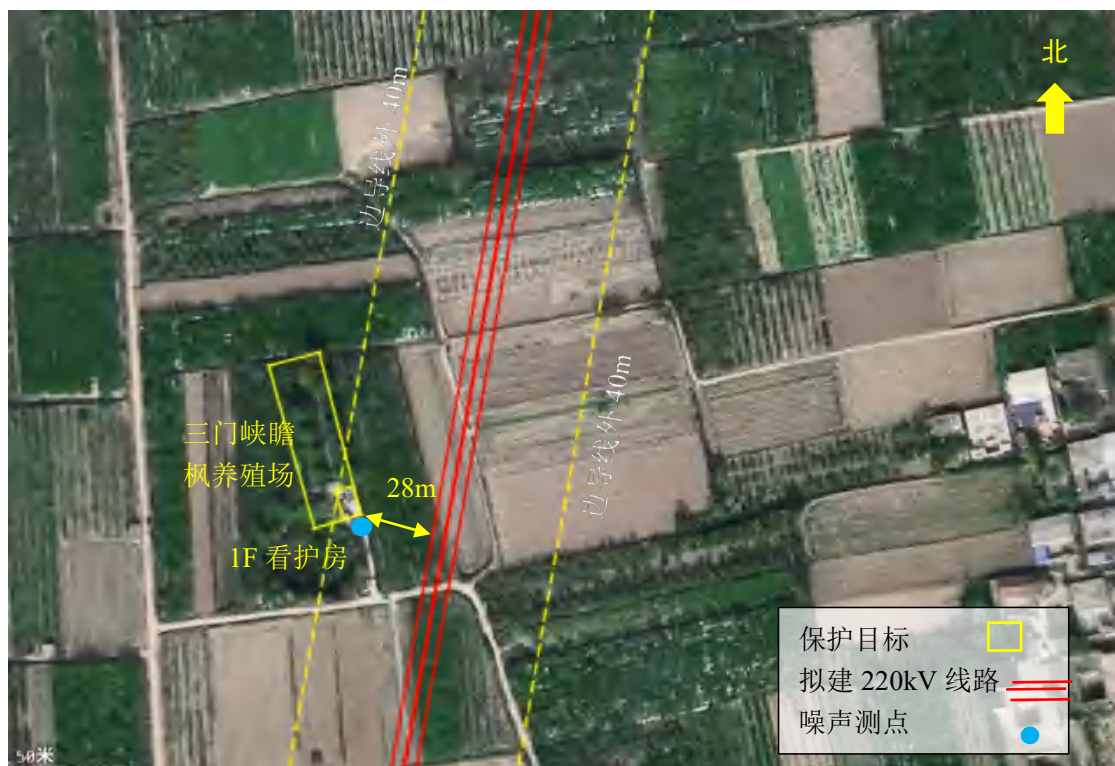
图 3-4 拟建 220kV 沿线保护目标声环境监测示意图（丁管营村）
