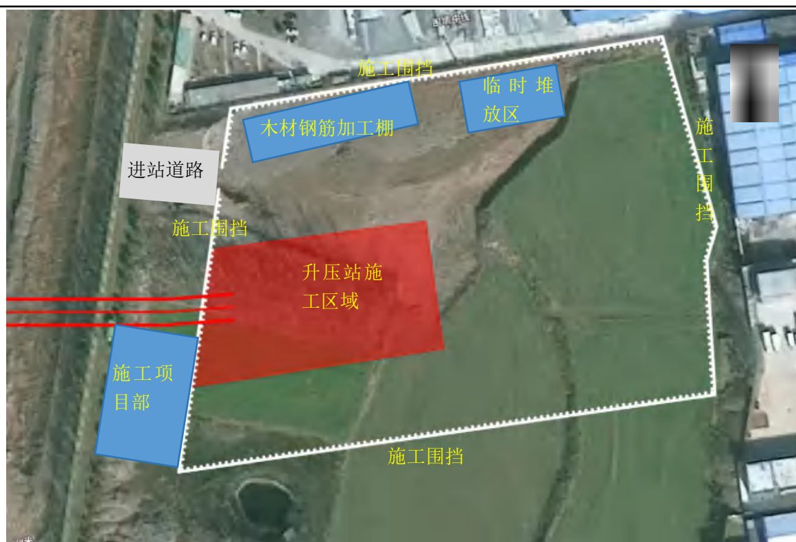
图 2-6 升压站工程施工布局图
