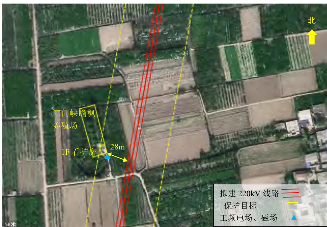
图 2-5 本工程沿线监测布点示意图
