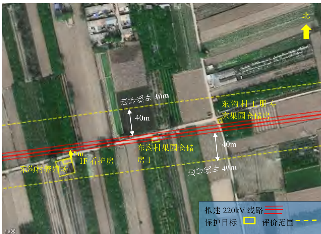
图 1-2.1 东沟村王朋寿家果园仓储房、果园仓储房 1、东沟村养殖场保护目标与本项目线路相对位置关系图
