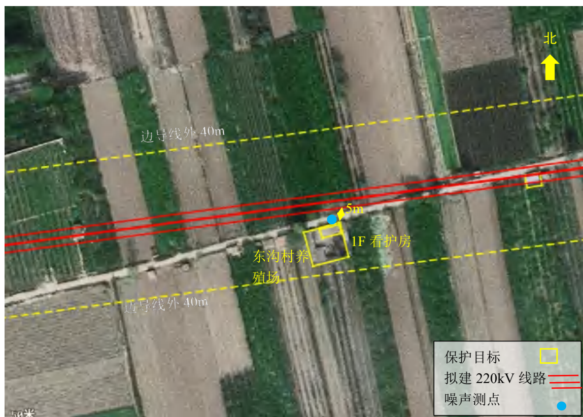
图 3-3 拟建 220kV 沿线保护目标声环境监测示意图（东沟村）
