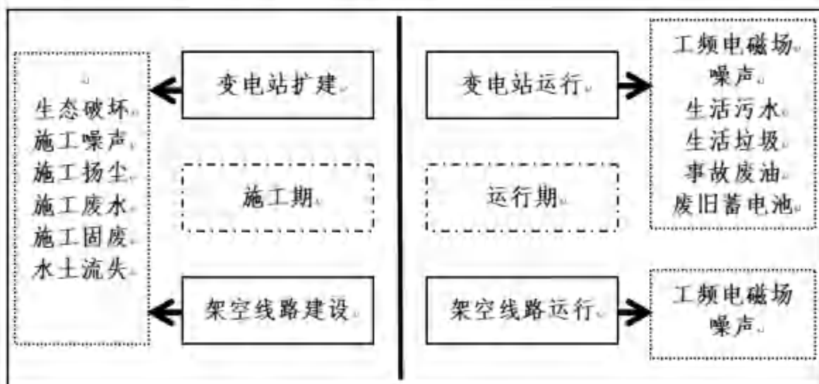
图 4-1 工艺流程与产污过程示意图
