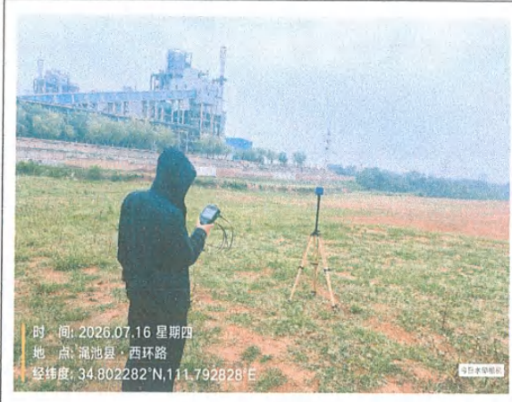
升压站区域北侧电磁检测照片
